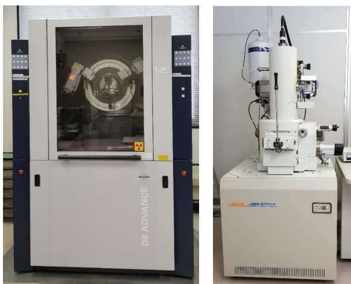
図1 X線回折装置(左)と電界放出型走査電子顕微鏡(右)
