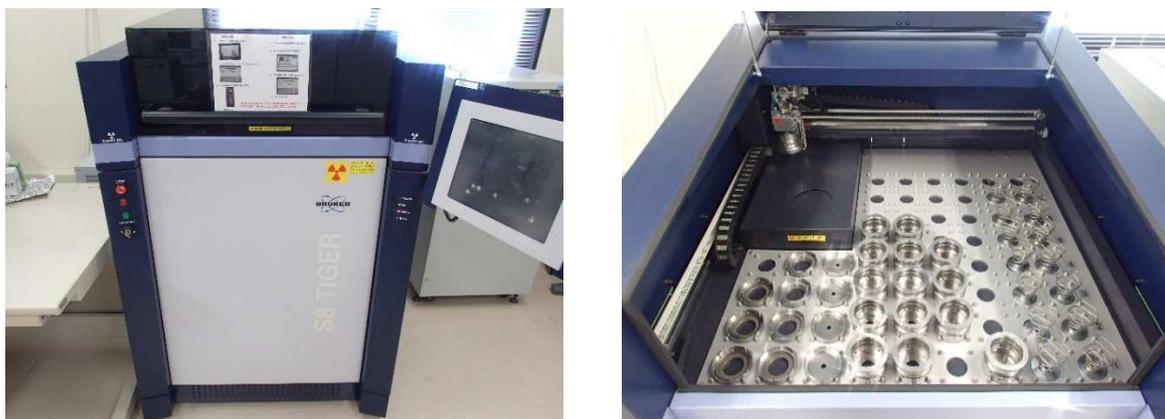
図1 蛍光 X 線分析装置の本体と試料設置部
