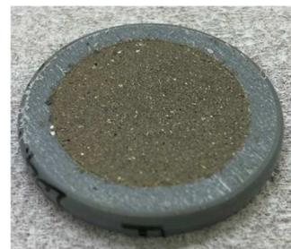
図2 XRF 測定用土ペレット
